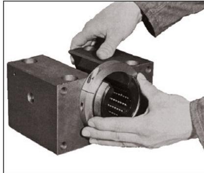
Nach dem Einschieben die Öffnung der Radial-Kugelbühse nach der Öffnung des Gehäuses ausrichten und den Montagering lösen.
