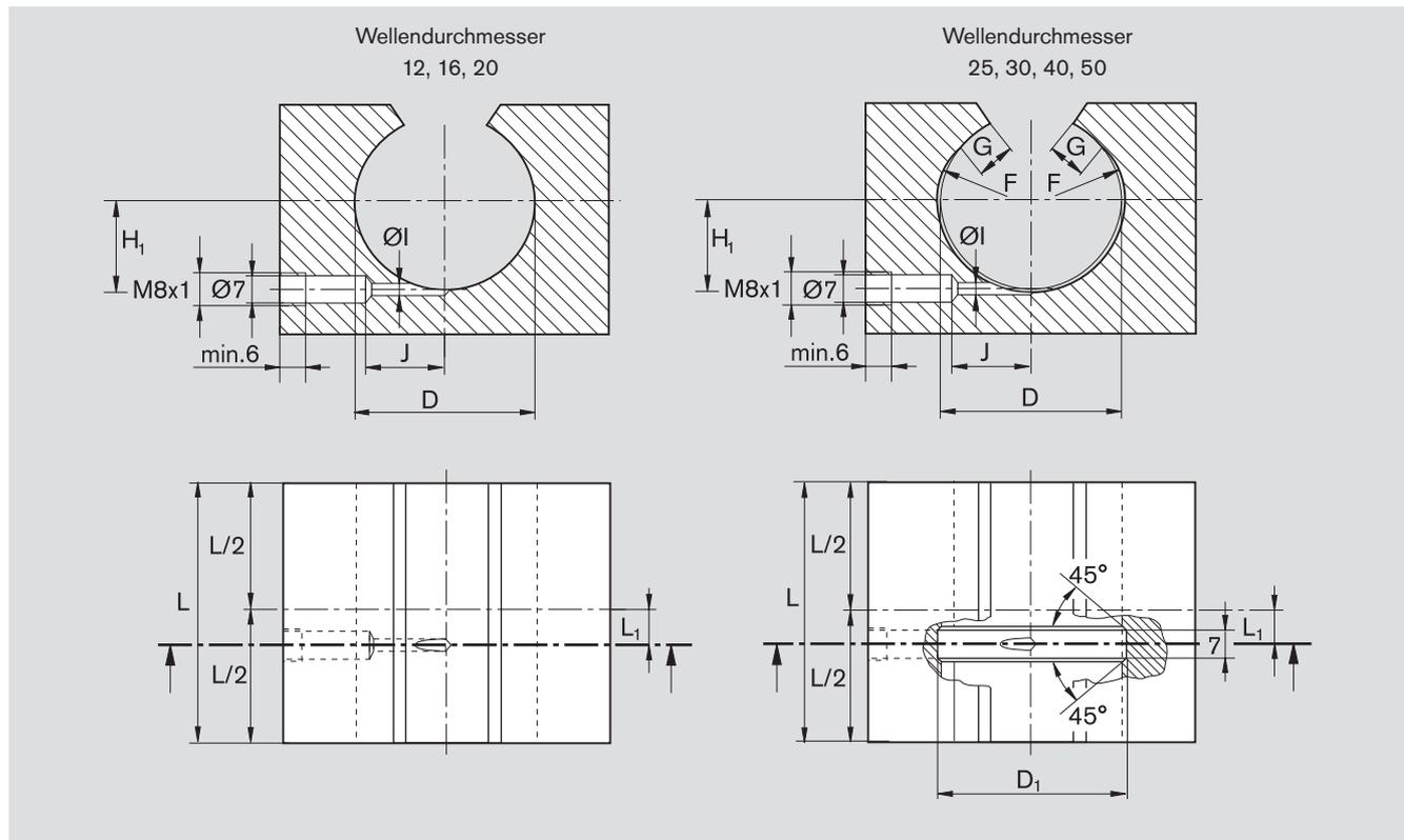
Die dargestellten Schmierkanäle sind ausgelegt für Fettschmierung siehe Kapitel „Schmierung“ auf Seite 22. Dichtringe axial sichern.
