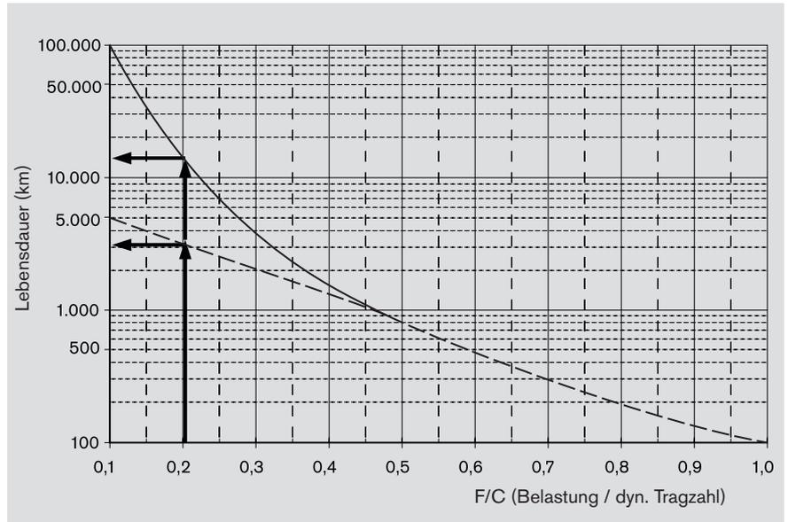
Das Diagramm zeigt Richtwerte für die lastabhängige Nachschmierung.
