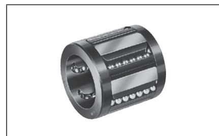
**Die Radial-Kugelbüchsen** sind hochpräzise Kugelbüchsen für die Bewegung sehr großer Massen. Die radiale Kugelumlenkung ermöglicht besonders viele Kugelreihen und höchste Tragzahlen.
