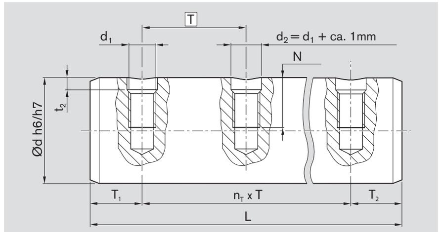
**Richtwerte zum Freibohren der gehärteten Randzone**
