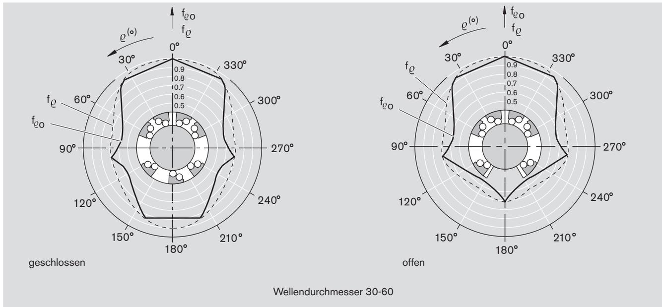
Super-Kugelhülsen können in jeder Einbaulage eingesetzt werden.
