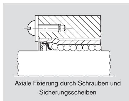
Axiale Fixierung durch Schrauben und
